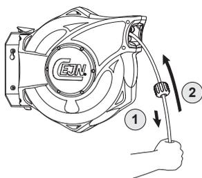
Para desbloquear el cable una vez finalizado su uso, (1) tire un poco de él hasta que el mecanismo de fijación deje de hacer clic.
