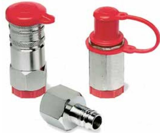
Compatibile con mezzi aggressivi, la serie 416 è ideale per applicazioni alimentari, off-shore e con vapore. La serie comprende modelli con doppia valvola o con valvola solo sulla femmina e che richiedono una sola mano per il collegamento. Cappucci anti-polvere in dotazione. Tenute in EPDM e Kalrez® disponibili su richiesta.
