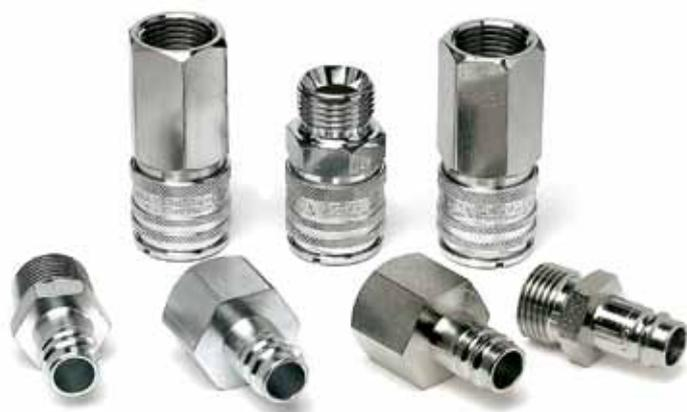
Grazie ad una pressione di esercizio di 200 bar, la serie 412 è particolarmente indicata per applicazioni con acqua e per pulizia ad alta pressione. La serie comprende attacchi con o senza valvola nonché nippoli senza valvola. Il collegamento richiede una mano sola. Altri materiali di tenuta sono disponibili su richiesta.
