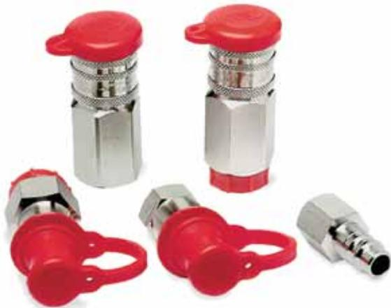
Compatibile con agenti aggressivi, la serie 326 è ideale per applicazioni alimentari, off-shore e con vapore. La serie 326 è innestabile con una sola mano sia nei modelli a semplice e doppia tenuta. Cappucci antipolvere in dotazione. Tenute in EPDM su richiesta.
