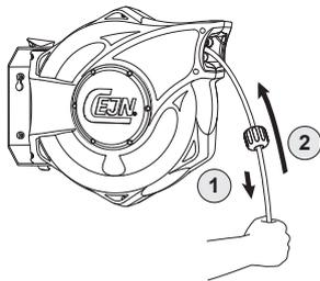
Para desbloquear o cabo quando terminar de o utilizar, (1) basta puxá-lo um pouco para fora e ouvir quando a lingueta para de emitir um ruído de "clique".
