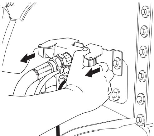
Koppla in plattan i parkeringsläget på rampen på rampen genom att TRYCKA IN den i rampplattan, hjälp samtidigt till att pressa ihop plattorna med fingrarna genom att hålla i handtagen på rampplattan.
