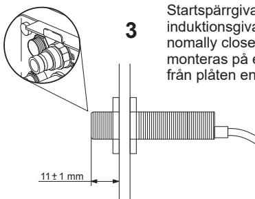
3 Startspärrgivare som är en induktionsgivare, typ PNP (typ: normally closed), levereras lös och skall monteras på ett avstånd av  $11\pm1$  mm från plåten enl. skiss.
