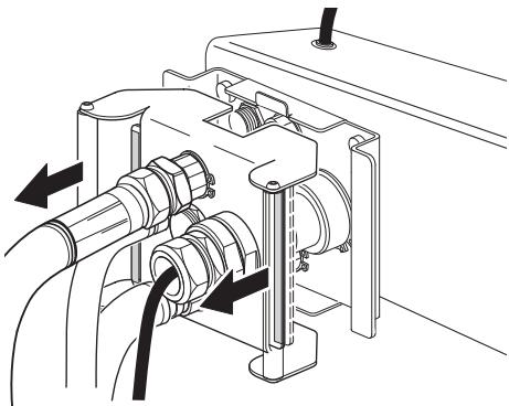
Verbinden Sie die Schlauchplatte im Bus, indem Sie den Stift zum mittleren Loch bewegen und die Schlauchplatte HINEIN-BEWEGEN. Drücken Sie zur Unterstützung gleichzeitig mit den Fingern die Platten zusammen, indem Sie die Griffe an der Busplatte festhalten.
