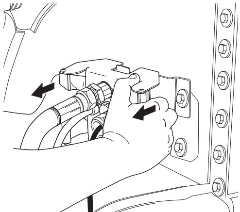
Achten Sie auf eine korrekte Positionierung. Aussparung und Blechvorsprung müssen zusammenpassen.
