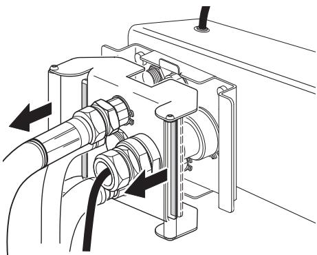
Koppla in slangplattan i bussen genom att styra in pinnen i mitthålet och TRYCK IN slangplattan, hjälp samtidigt till att pressa ihop plattorna med fingrarna genom att hålla i handtagen på bussplattan.
