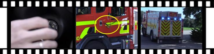
Le démarrage du véhicule active l'éjection automatique!
